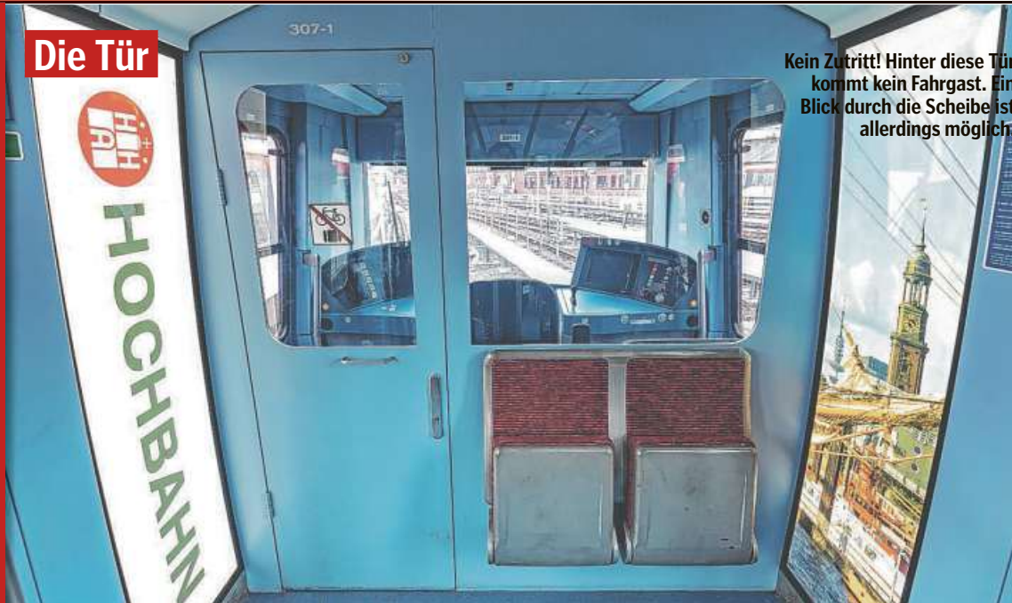
Der Triebwagen des Typs DT5 stammt aus dem Jahr 2012. Der Führerstand kann von drei Seiten betreten werden.
